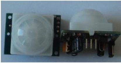
**概述:** 基于红外线技术的自动控制产品, 灵敏度高, 可靠性强, 超低电压工作模式, 广泛应用于各类自动感应电器设备。
